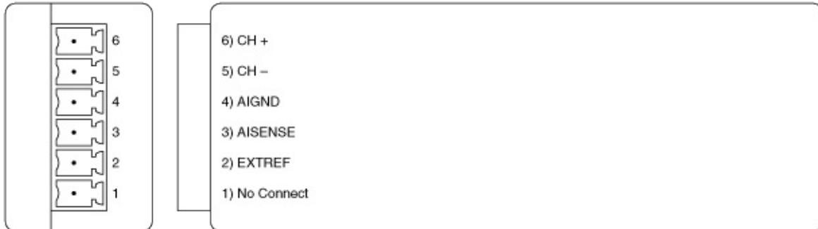
In der Tabelle werden die Signale aufgeführt, die nach dem Einstecken des SSC-FT01 in einstufige SCC-Steckplätze zur Erfassung analoger Signale (J1-J8) oder zur Ausgabe analoger Signale (J17 und J18).
