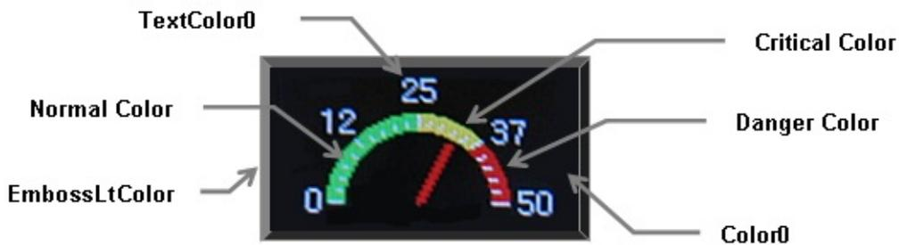
**Half Meter with Arc enabled**
